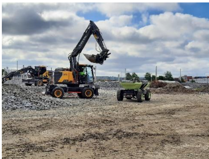
Figur 27 - Batterielektrisk större prototyp-hjulgrävare och fjärrstyrd lastbärare
