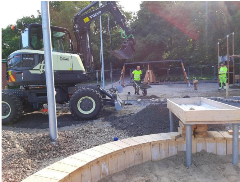
Figur 20 - 6tons batterielektrisk prototyp-hjulgrävare, Terapistigen, Göteborgs Stad
