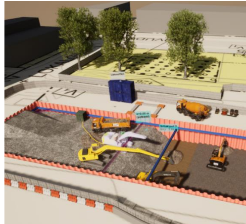
Figur 14 - Nätansluten 30tons grävare i simuleringsmiljö
